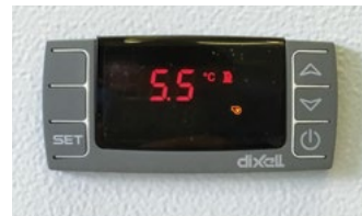
Controlerul cu microprocesor XR60CX are un afișaj integrat cu pictograme.
